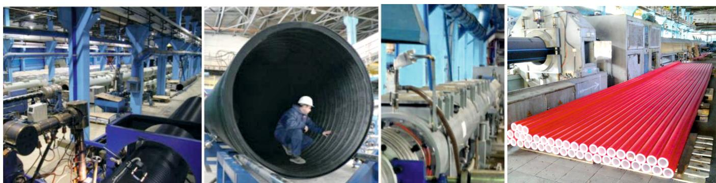
ПРЕДВАРИТЕЛЬНО ИЗОЛИРОВАННАЯ ТРУБНАЯ КОНСТРУКЦИЯ «ПРОТЕРМ ТИП 1», с напорной полимерной трубой из материала PE-RT тип II (полиэтилен повышенной термостойкости) «HOSTALEN 4731 В» компаний LyondellBasell и Sabic с антидиффузионным (барьерным) слоем, отвечает всем требованиям и стандартам Украины. По требованию заказчика может изготавливаться с применением проводников системы ОДК (контроль намокания ППУ)
