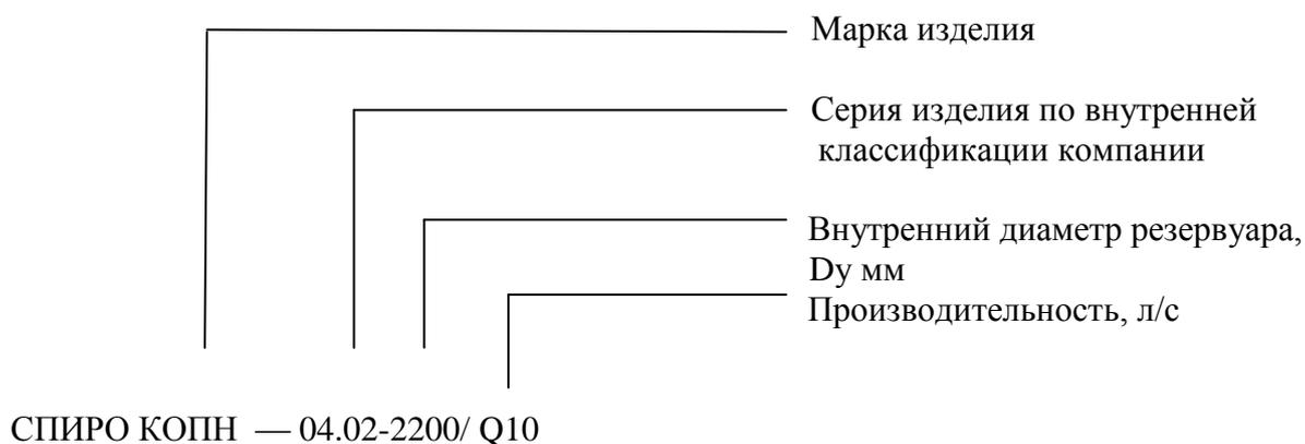
1.5. Пример обозначения: СПИРО КОПН — 04.02-2200/ Q10 (комплекс очистки сточных вод от песка и нефтепродуктов СПИРО КОПН производительностью 10 л/с).
