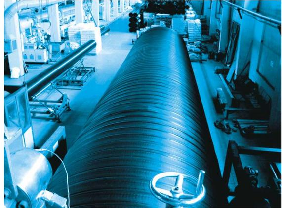
На производственном оборудовании выпускаются полимерные трубы для сетей водоснабжения, газоснабжения, водоотведения и теплоснабжения диаметрами от 20 до 3000 мм, колодцев наружной канализации, диаметром до 2200 мм для систем различной конструкции, а также резервуаров различной конфигурации и функционального назначения.
