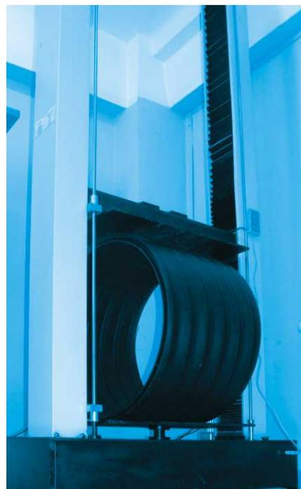
Способность к деформациям под нагрузкой выражается через кольцевую жесткость трубы, которая рассчитывается по уравнению:
